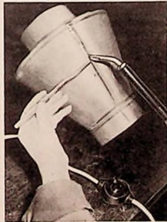
zum Signieren von Holz, Pappe, Leder oder Kunststoffen, oder mit einem Einsatz zum Schneiden und gleichzeitigen Säumen von Kunststoffen, Mipolam und PVC-Material versehen werden. Das Bild zeigt den Kolben mit schwerem Kupfer-einsatz beim Lötten einer Zinkabdeckung, eine Arbeit wie sie z. B. auch bei Antennen-Anlagen vorkommen kann. Heizkörper und Lötensatz sind leicht auszuwechseln, so daß sich dadurch eine recht vielseitige Anwendbarkeit ergibt (Inco, F. W. Bäumer, Ahlen/Westf.).
